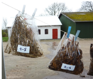
Hvede- og majshalm hænger til afdrypning, ved Sugvevnmåling: Vejning af majshalm.
