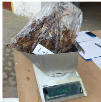
Hvede- og majshalm hænger til afdrypning, ved Sugvevnmåling: Vejning af majshalm.
